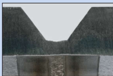
Сварка RMD® нержавеющей сталей
