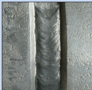
Сварка нержавеющей сталей
